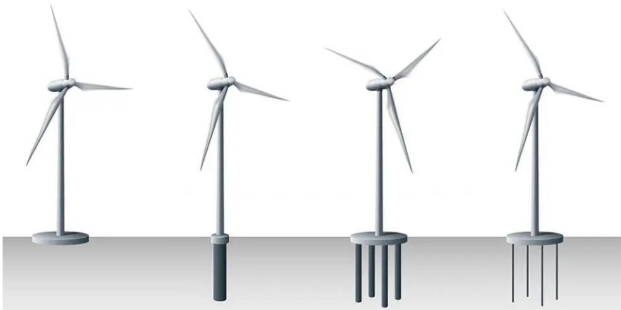
Joonis 3. Tuulikute vundamentide tüübid 15 . Vasakult gravitatsioonivundament, ühevaialine vaivundament ehk monovaivundament, plaatvundament kombineeritud vaiadega, plaatvundament kombineeritud ankrutega.
